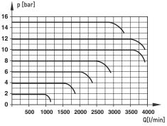
Portata caratteristiche per i modelli con 16 mm diametro nominale, piastra di connessione 1 / 2 "(NG12) e P1 con 7 bar, 12 bar, 17 bar
