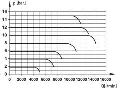
Portata caratteristiche per i modelli con 16 mm diametro nominale, piastra di connessione 3 / 4 "(NG20) e P1 con 7 bar, 12 bar, 17 bar
